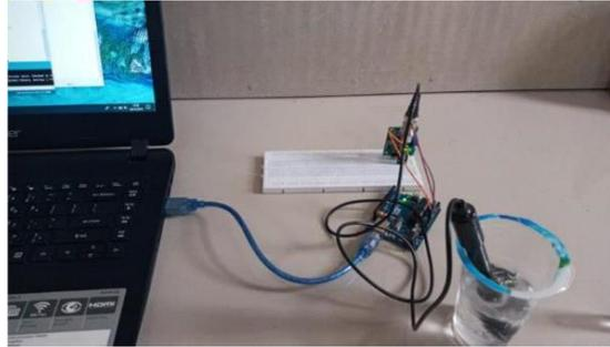
Gambar 6. Proses pengujian sampel air Pengujian kekeruhan air
