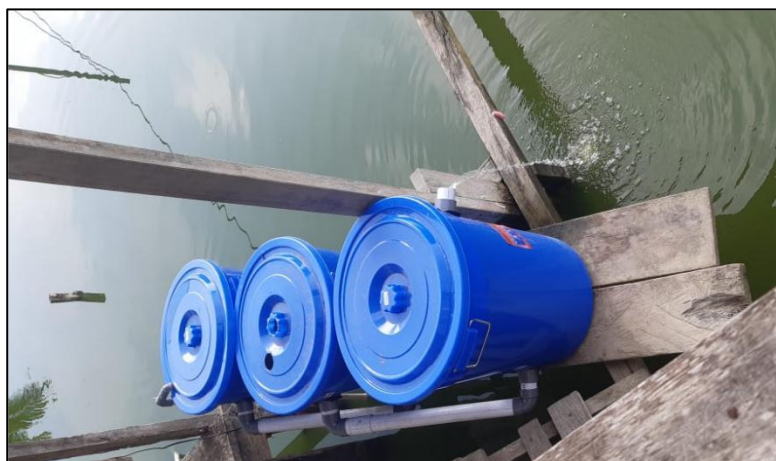
Gambar 5. Sistem pengolahan air dengan penerapan karbon aktif
