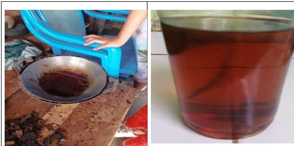
Gambar 5. Minyak jelantah dipanaskan dan diadsopsi dengan kulit pisang kapok dan dipisahkan dengan penyaring
