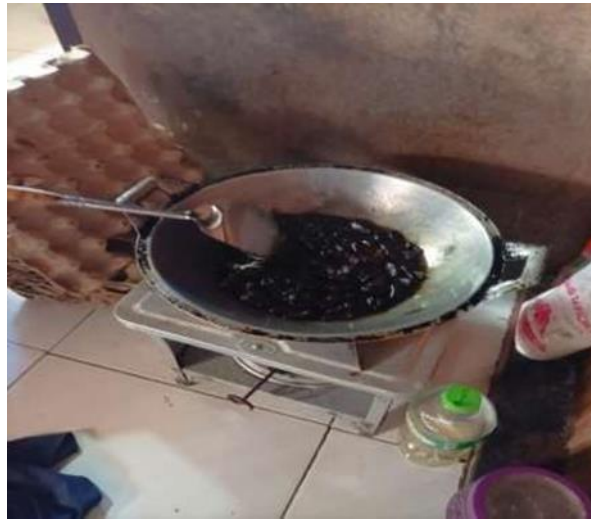
Gambar 4. Minyak jelantah dipanaskan dan diadsopsi dengan kulit pisang kepok
